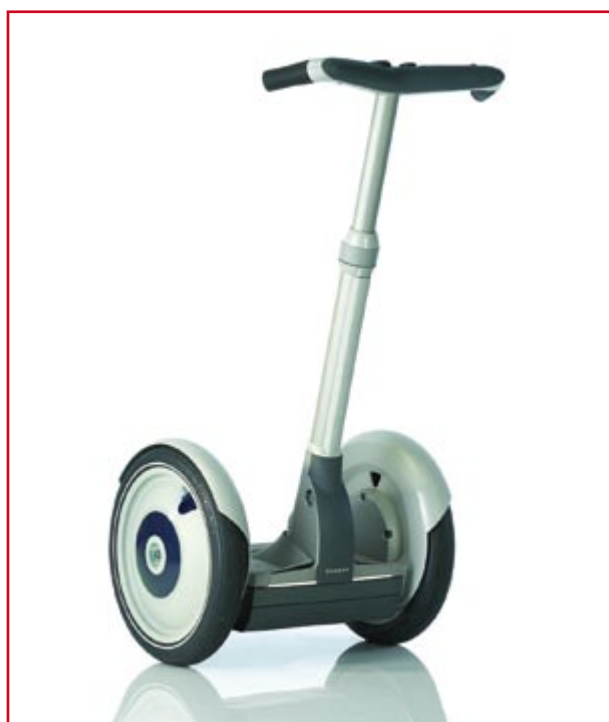
Imagen 1. Los sistemas de transporte individual como el Segway sólo se pueden dominar con giróscopos.
