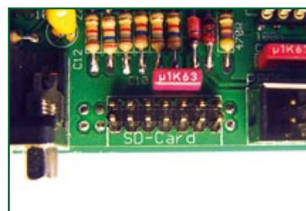
Figura 5. Para poder conectar una tarjeta de memoria SD entre las los pines del conector, se doblan las dos filas entre sí hasta quedar a una distancia de aproximadamente 1,5 mm.
