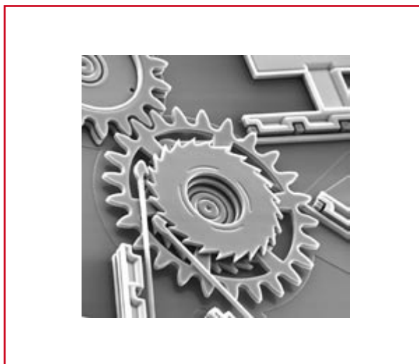
Imagen 7. Con algunos esfuerzos se pueden fabricar engranajes funcionales con MEMS.
