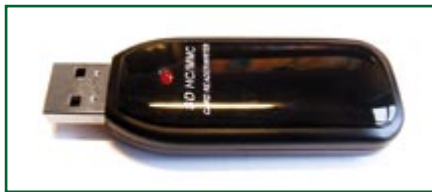
Figura 7. Un lector de tarjeta barato proporciona, tras su extracción, una ranura para la tarjeta SD.
