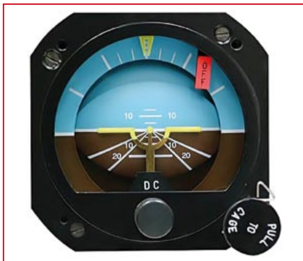
Imagen 3. El horizonte artificial en la cabina de piloto de un avión contiene un giróscopo con suspensión cardánica e impulsado de forma eléctrica o neumática.
