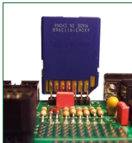
Figura 6. Una tarjeta SD conectada entre los pines del conector.
