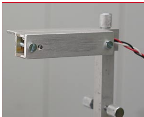
Imagen 4. El sensor de luz montado en una carcasa.
