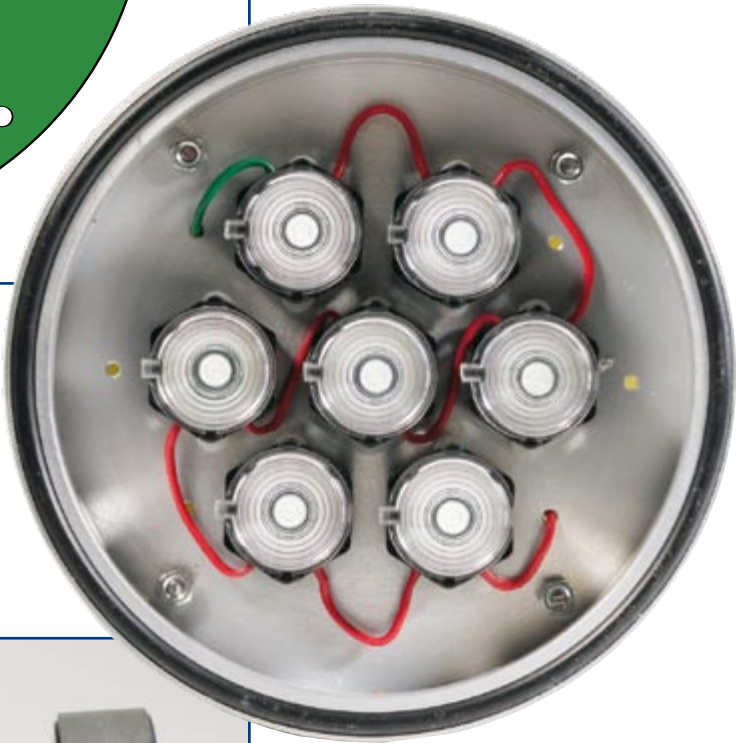
Figura 5. Los LED se colocan en una gran placa de aluminio, que además sirve de disipador térmico.
