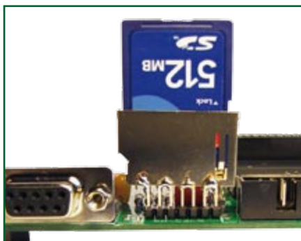
Figura 9. Los pines sin función del conector se sueldan para mayor estabilidad a la chapa que cubre la ranura de la tarjeta SD.
