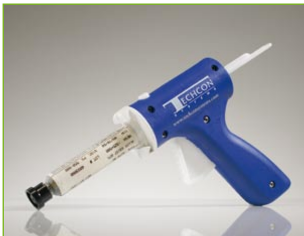
Figura 2. No apto para remilgados! Jeringuillas y 'pistolas' como las que se muestran aquí son herramientas de gran valor para la aplicación de pasta de soldadura en los puntos de soldadura de componentes SMD.
