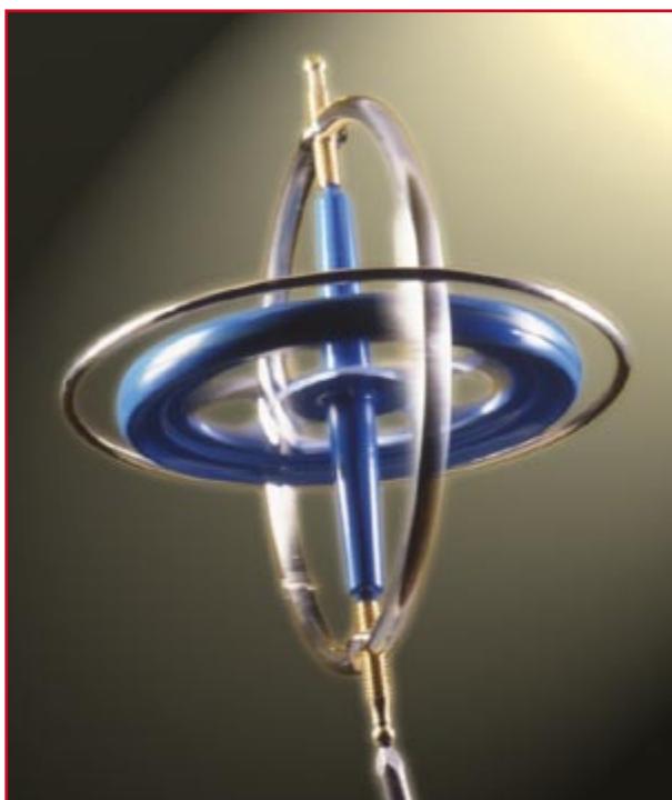
Imagen 2. Gracias a la fuerza de Coriolis, un giróscopo rotatorio puede mantener el equilibrio fácilmente en la punta de una uña.
