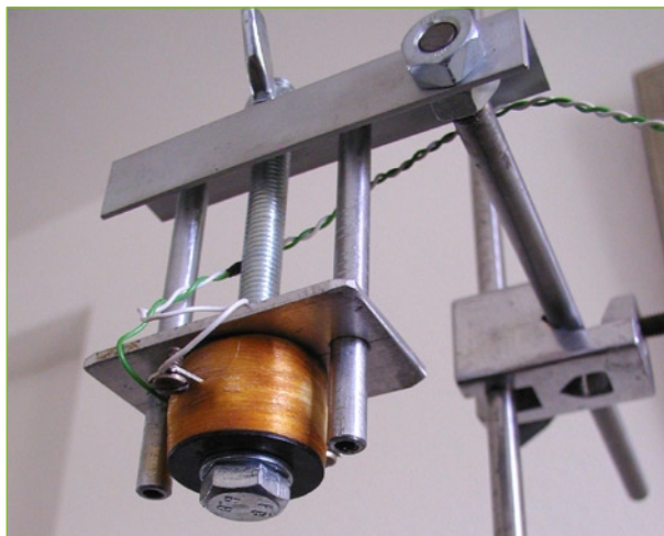
Figure 2. Lorsqu'il est possible de positionner la hauteur de l'aimant par vis, le réglage devient un jeu d'enfant.
