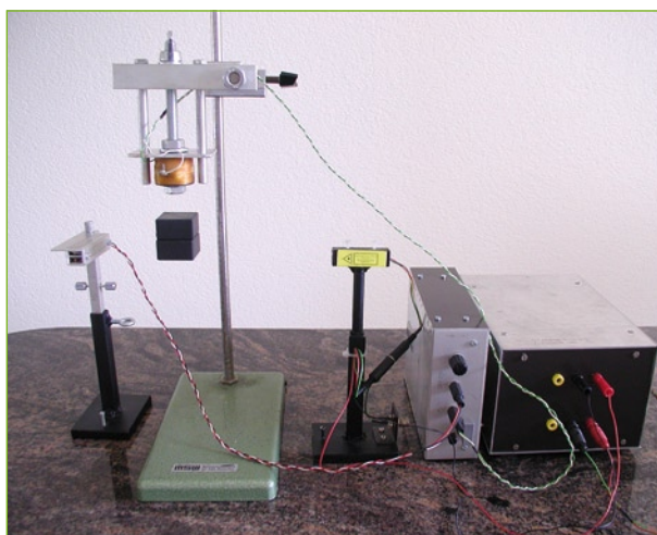
Figure 1. Coup d'oeil sur la construction : à gauche le photocapteur, sur le pied est monté l'électro-aimant, sous lequel flotte le cube prenant la forme d'aimants permanents parallélépipédiques rectangulaires. On peut identifier la source de lumière sous la forme d'un module à diode laser. Le coffret à droite abrite l'électronique de la régulation et l'alimentation.
