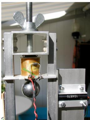
Laser, Startsensor, Kugel und Elektromagnet
