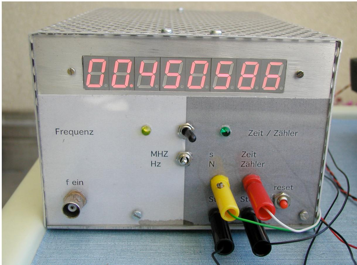
Das fertig gestellte Messgerät für Frequenz- und Zeitmessung sowie Ereigniszähler
