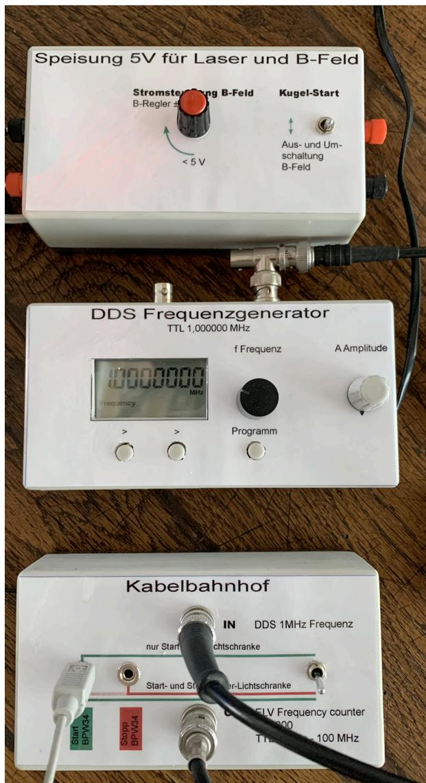
Abb. 3.5.2 Stromversorgung, DDS-Frequenznormal, Kabelbahnhof mit Signalaufbereitung
