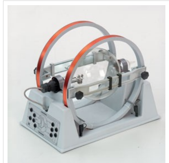
Fadenstrahlrohr mit Helmholtzspulenpaar
