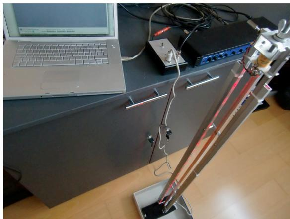
Figure 2 L'électronique et l'appareil MOTU 828
